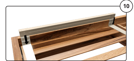
10 An Bettkante platzieren und Höhe der Winkel einstellen. Die sichtbaren Schrauben können jetzt festgedreht werden.
